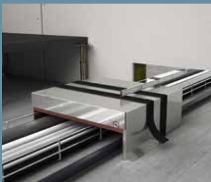
Mesure de l'épaisseur de la paroi et mise en place des bandes en graphite à une distance appropriée
