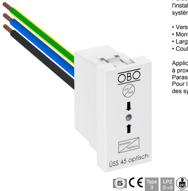
Parasurtenseur / protection fine de réseau de type 3 selon EN 61643-11 pour l'installation dans des goulottes Rapid 45, des goulottes d'appareillages et des systèmes sous plancher.
