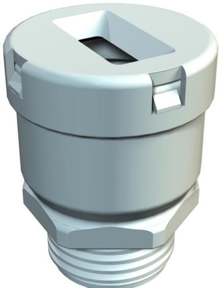
Entrée avec raccord d'étranglement pour câbles plats, avec filetage PG selon la norme DIN 40430, indice de protection IP 31, avec bague d'étanchéité pré-montée de type 107/F.
