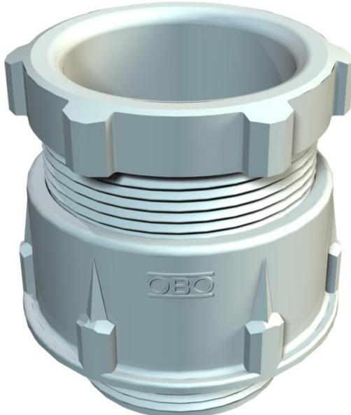
Presse-étoupe standard, forme A selon DIN 46320 doté d'une bague d'étanchéité simple en NR/SBR, avec raccord fileté métrique selon la norme CEI 423.
