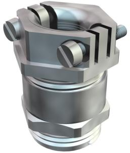
Presse-étoupe avec décharge de traction par bride transversale à action centrale dans le boulon de pression, protection anti-torsion de câbles mobiles par boulon de pression fortement arrondi.
