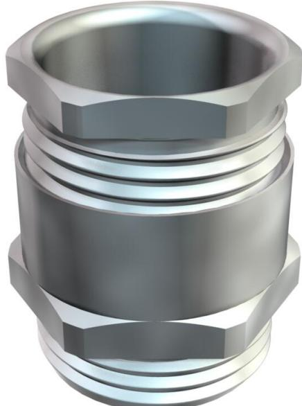
Presse-étoupe avec raccord intermédiaire à tête hexagonale, de forme C4 selon la norme DIN 46320 avec filet de raccordement métrique selon la norme DIN EN 60423 ou ISO 68. Bagues de pression en acier, galvanisées et transparence passive. Bague d'étanchéité en NR/SBR.
