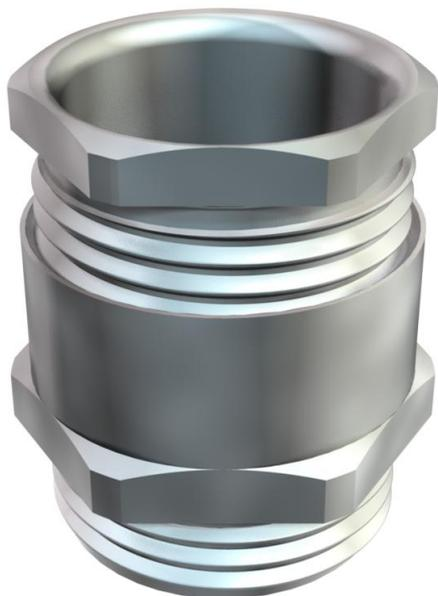
Presse-étoupe avec raccord intermédiaire à tête hexagonale, de forme C4 selon la norme DIN 46320 avec filetage métrique selon la norme DIN EN 60423 ou ISO 68. Bagues de pression en acier, galvanisées et transparence passive. Bague d'étanchéité en NR/SBR.
