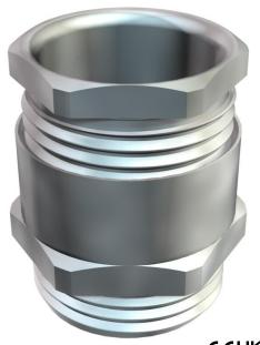
Presse-étoupe avec raccord intermédiaire à tête hexagonale, de forme C4 selon la norme DIN 46320 avec filet de raccordement PG selon la norme DIN 40430. Bagues de pression en acier, galvanisées et transparence passive. Bague d'étanchéité en NR/SBR.
