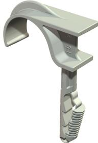
Les brides enfichables sont destinés à la pose de câbles et de tubes sur les murs et plafonds ainsi qu'à la pose de tubes flexibles sur les supports en béton et en plâtre. Les brides enfichables simples remplacent les clips de fixation à clou dans le béton et le béton cellulaire. L'avantage des brides enfichables est qu'ils doivent simplement être emboîtés dans le trou de montage. L'utilisation de chevilles et de vis devient alors inutile.
