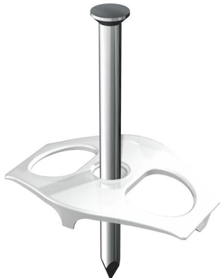
Avec clou prémonté en acier galvanisé, Ø 3 mm ou 3,5 mm pour la fixation de conduits dans les fentes de mur et sur la maçonnerie de 1 ou 2 conduits NYM 3 x 1,5/2,5 mm<sup>2</sup> ou 1 ou 2 conduits NYM 5 x 1,5/2,5 mm<sup>2</sup>.
