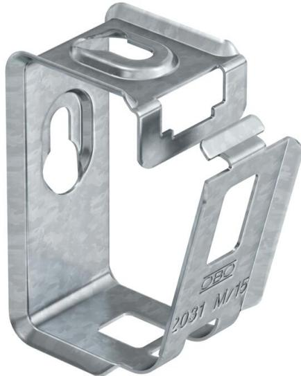
Passe-câbles métalliques pour une résistance mécanique élevée, même en cas d'incendie. Approprié pour un montage sécurisé au-dessus de plafonds coupe-feu. Autorisé également comme structure porteuse spécifique aux câbles pour le maintien en fonction selon la norme DIN 4102 partie 12. Pour montage au mur et au plafond. Fermeture ouvrable sans outil.
