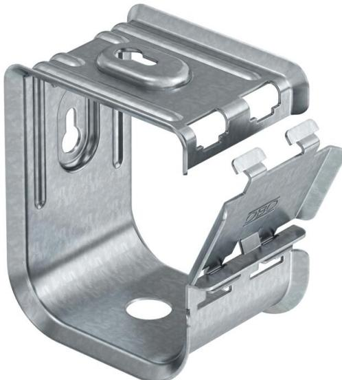
Passe-câbles métalliques pour une résistance mécanique élevée, même en cas d'incendie. Approprié pour un montage sécurisé au-dessus de plafonds coupe-feu. Autorisé également comme structure porteuse spécifique aux câbles pour le maintien en fonction selon la norme DIN 4102 partie 12. Pour montage au mur et au plafond. Fermeture ouvrable sans outil.
