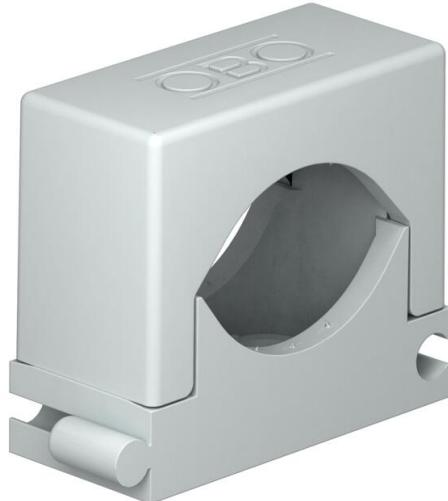
Collier universel pour la fixation individuelle de câbles, conduites et tubes, toutes les dimensions peuvent être combinées entre elles, avec embase adhésive, trou oblong et avec filetage M6.
