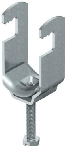
Bride de fixation pour la fixation de câbles et de tubes. Convient aux fers plats, coudés et en U de 4 à 12 mm d'épaisseur. Les patins de pression métalliques possèdent des arêtes très arrondies pour éviter que les câbles ne soient endommagés.
