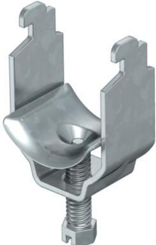
Convient pour tous les rails profilés en C avec une ouverture de 11 à 12 mm; hauteur intérieure d'au moins 6,5 mm et largeur intérieure d'au moins 18,5 mm; les plaques de pression métalliques ont des arêtes très arrondies sur toutes les faces pour éviter d'endommager les câbles.
