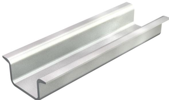
Rail DIN profilé 35 x 15 mm similaire à la norme DIN EN 60715 (anciennement DIN EN 50022), néanmoins avec une épaisseur du matériau de 1,5 mm.
