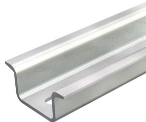
Rail DIN profilé 35 x 15 mm similaire à la norme DIN EN 60715 (anciennement DIN EN 50022), néanmoins avec une épaisseur du matériau de 1,5 mm.
