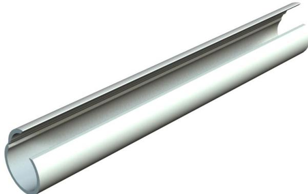
Tube ouvert Quick-Pipe en plastique pour pose apparente de câbles et conduites, en intérieur et extérieur protégé. Montage au mur et au plafond avec colliers Quick, Star-Quick et Multi-Quick. Fermeture et ouverture sans outils par rotation dans le collier. Utilisation possible à des températures comprises entre -25 °C et +60 °C.
