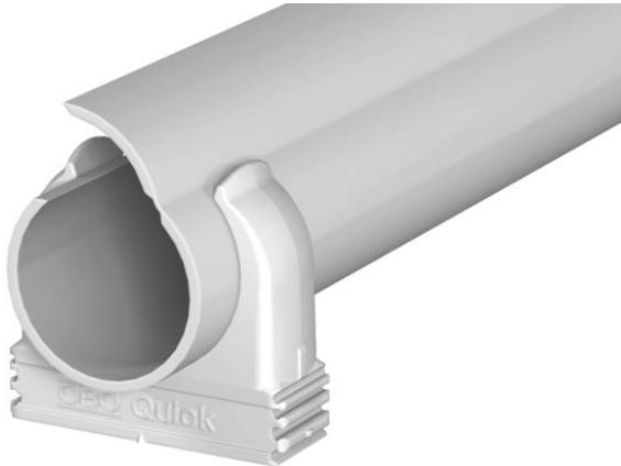
Kit composé de tubes d'installation électrique Quick-Pipe et de colliers en saillie Quick. Pour pose apparente de câbles et conduites, en intérieur et extérieurs protégés. Fixation universelle au mur et au plafond. Comprend 20 m de tubes d'une longueur de 2 mètres et 60 colliers Quick. Utilisation possible à des températures comprises entre -25 °C et +60 °C.
