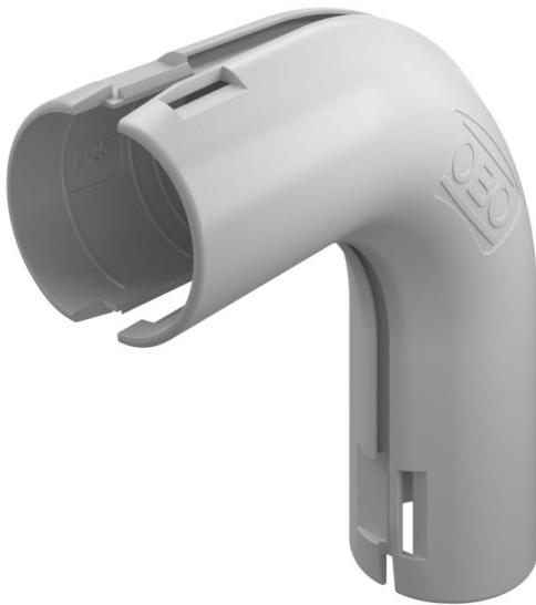
Pièce préformée pour tubes d'installations électriques en matière plastique pour créer des coudes à 90°. Convient aux tubes OBO Quick-Pipe ou tubes ondulés. Fermeture et ouverture sans outils. Utilisation possible à des températures comprises entre -25 °C et +60 °C.
