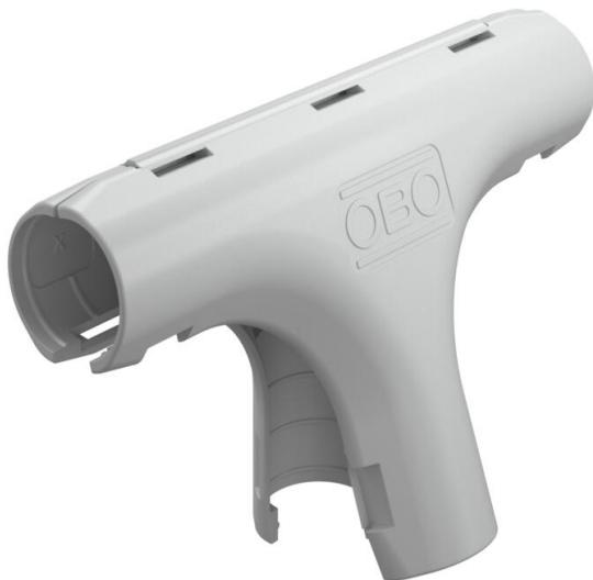
Pièce préformée pour tubes d'installation électrique en matière plastique pour créer des dérivations en T. Convient aux tubes OBO Quick-Pipe ou tubes ondulés. Fermeture et ouverture sans outils. Utilisation possible à des températures comprises entre -25 °C et +60 °C.
