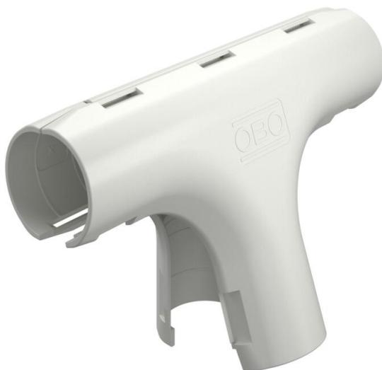
Pièce préformée pour tubes d'installation électrique en matière plastique pour créer des dérivations en T. Convient aux tubes OBO Quick-Pipe ou tubes ondulés. Fermeture et ouverture sans outils. Utilisation possible à des températures comprises entre -25 °C et +60 °C.
