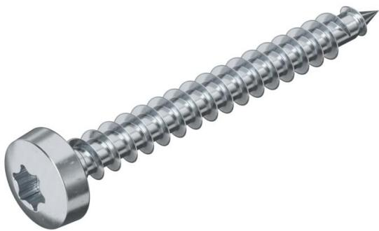
Acier trempé et galvanisé, revêtement Hostaflon. Panhead avec embout en T (six pans creux), de Ø 3 mm T10, Ø 3,5 mm T15, Ø 4 et 4,5 mm T20, Ø 5 mm T25.
