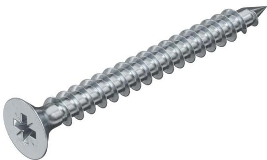
Acier trempé et galvanisé, revêtement Hostaflon. Tête fraisée avec empreinte cruciforme (Pozidrive taille 2 sauf Ø 6 mm Pozidrive taille 3). L'utilisation de vis SPRINT permet de réduire considérablement le temps de visage par rapport aux vis conventionnelles. Cet avantage perceptible est possible grâce à une pointe agrippante sur la 1re prise qui conduit au filetage à 2 pas. Domaines d'application : bois, panneaux d'aggloméré, placoplâtre, cheville plastique.
