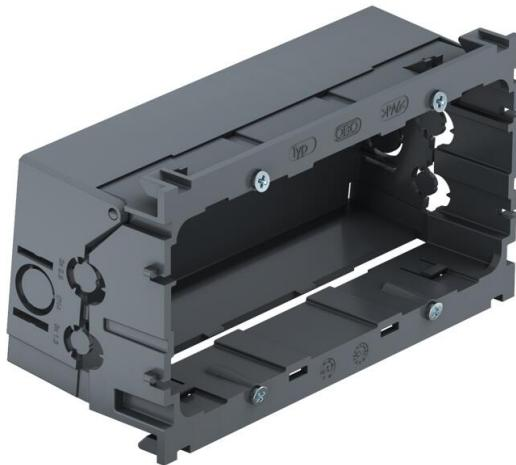
Boîtier d'appareillages emboîtables par l'avant pour gammes d'interrupteurs standards pour le montage de 2 appareillages d'installation individuelle ou d'une prise de courant multiple avec fiche de terre. Avec socle rabattable et amovible si nécessaire pour le raccordement rapide des câbles, ainsi que des ouvertures d'entrée pour des diamètres jusqu'à 14 mm. Version sans halogène. Largeur de voie de fixation verticale 60 mm.
