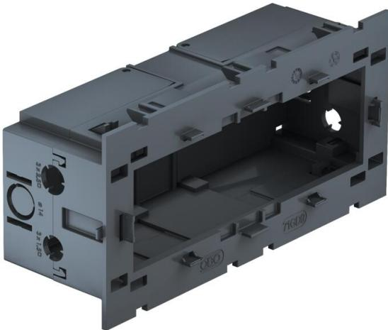
Boîtier d'appareillage emboîtable triple pour système Modul 45®, avec socle rabattable et amovible si nécessaire pour le raccordement rapide des câbles, avec des ouvertures d'entrée pour des diamètres jusqu'à 14 mm.
