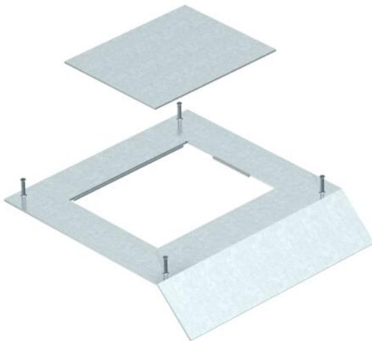
Couvercle pour socle de conduit AIK/U pour le montage d'un boîtier de sol de taille nominale 6 ; ouverture de montage fermée par un obturateur en alu de 2 mm. Le couvercle du conduit est fermement vissé sur les profilés latéraux Al du socle du conduit. Le chanfrein du couvercle dépasse le socle du conduit selon un angle de 45°.
