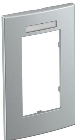
Cadre de recouvrement par l'avant pour les appareils encastrables Module 45, double, avec zone de marquage pour installation verticale, à encastrer dans le boîtier d'appareillages 71GD13 ou dans un support de montage 71MT2 45. Pour l'installation dans des canaux d'allège Rapid 80 et des colonnes de distribution ISS.
