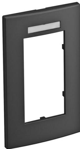
Cadre de recouvrement par l'avant pour les appareils encastrables Module 45, double, avec zone de marquage pour installation verticale, à encastrer dans le boîtier d'appareillages 71GD13 ou dans un support de montage 71MT2 45. Pour l'installation dans des canaux d'allège Rapid 80 et des colonnes de distribution ISS.
