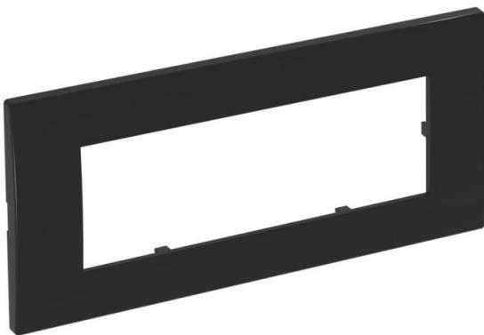
Cadre de recouvrement par l'avant pour les appareils encastrables Module 45, triple, sans zone de marquage pour installation verticale, à encastrer dans le boîtier d'appareillages 71GD9-2 ou dans un support de montage 71MT3 45-2. Pour l'installation dans des canaux d'allège Rapid 80 et des colonnes de distribution ISS.
