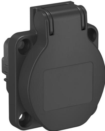
Prise de courant encastrée à contact de protection 0° avec couvercle rabattable, avec bornes enfichables, 2 pôles, 16 A, 250 V~, avec bornes de raccordement selon CEI 60884-1. Indice de protection : IP 44 Indice de protection: IP 44
