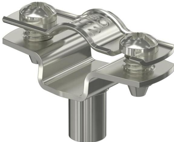
Collier d'écartement pour le montage de tubes et câbles au mur, au plafond et au sol. Avec partie supérieure autobloquante. Fixation par l'embase avec filetage intérieur. Surfaces G et FT à partir de la taille 20 des colliers convenant au montage avec cloueur ou pistolet de scellement.
