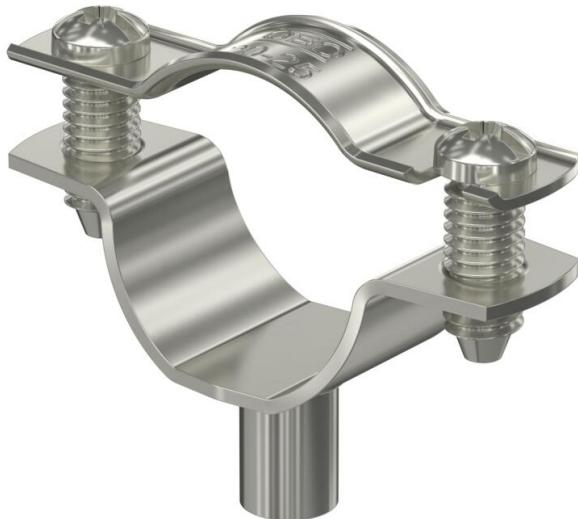
Collier d'écartement pour le montage de tubes et câbles au mur, au plafond et au sol. Avec partie supérieure autobloquante. Fixation par l'embase avec filetage intérieur. Surfaces G et FT à partir de la taille 20 des colliers convenant au montage avec clouer ou pistolet de scellement.
