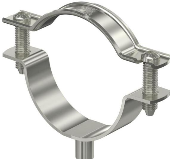
Collier d'écartement pour le montage de tubes et câbles au mur, au plafond et au sol. Avec partie supérieure autobloquante. Fixation par l'embase avec filetage intérieur. Surfaces G et FT à partir de la taille 20 des colliers convenant au montage avec cloueur ou pistolet de scellement.
