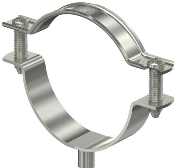
Collier d'écartement pour le montage de tubes et câbles au mur, au plafond et au sol. Avec partie supérieure autobloquante. Fixation par l'embase avec filetage intérieur. Surfaces G et FT à partir de la taille 20 des colliers convenant au montage avec clouer ou pistolet de scellement.
