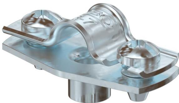
Collier d'écartement pour le montage de tubes et câbles au mur, au plafond et au sol. Avec partie supérieure autobloquante. Fixation par l'embase avec filetage intérieur. Surfaces G et FT à partir de la taille 20 des colliers convenant au montage avec clouer ou pistolet de scellement.
