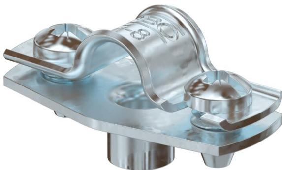
Collier d'écartement pour le montage de tubes et câbles au mur, au plafond et au sol. Avec partie supérieure autobloquante. Fixation par l'embase avec filetage intérieur. Surfaces G et FT à partir de la taille 20 des colliers convenant au montage avec cloueur ou pistolet de scellement. Homologation pour la sécurité de fonctionnement selon la norme DIN 4102 partie 12, classes de sécurité de fonctionnement E30 à E90.
