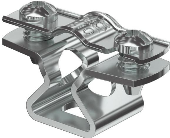
Collier d'écartement pour le montage de tubes et câbles au mur, au plafond et au sol. Avec partie supérieure autobloquante. Fixation par trou oblong. À partir de la taille 20 des colliers, convenant au montage avec cloueur ou pistolet de scellement.
