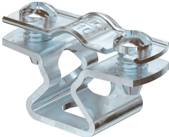
Collier d'écartement pour le montage de tubes et câbles au mur, au plafond et au sol. Avec partie supérieure autobloquante. Fixation par trou oblong. Homologation pour la sécurité de fonctionnement selon la norme DIN 4102 partie 12, classes de sécurité de fonctionnement E30 à E90.
