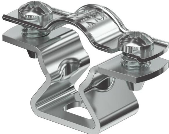
Collier d'écartement pour le montage de tubes et câbles au mur, au plafond et au sol. Avec partie supérieure autobloquante. Fixation par trou oblong. À partir de la taille 20 des colliers, convenant au montage avec cloueur ou pistolet de scellement.
