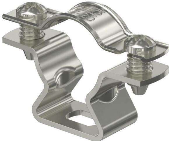
Collier d'écartement pour le montage de tubes et câbles au mur, au plafond et au sol. Avec partie supérieure autobloquante. Fixation par trou oblong. Homologation pour la sécurité de fonctionnement selon la norme DIN 4102 partie 12, classes de sécurité de fonctionnement E30 à E90.
