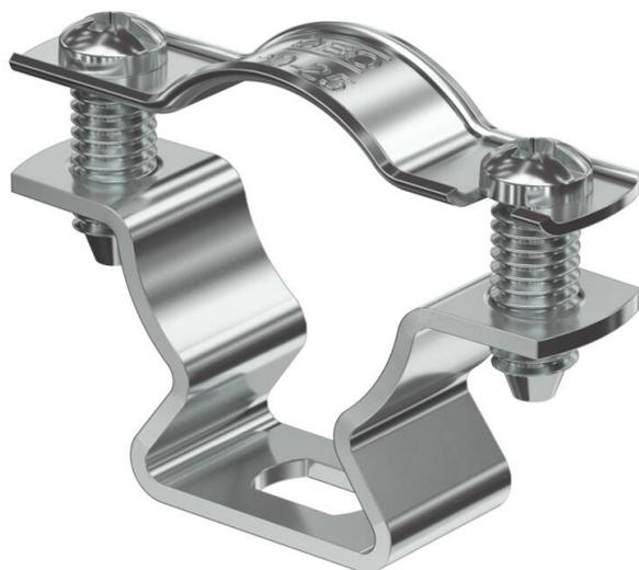
Collier d'écartement pour le montage de tubes et câbles au mur, au plafond et au sol. Avec partie supérieure autobloquante. Fixation par trou oblong. À partir de la taille 20 des colliers, convenant au montage avec cloueur ou pistolet de scellement.
