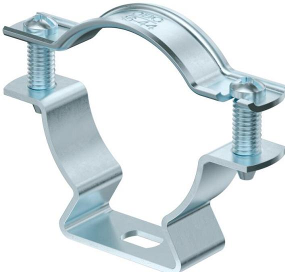
Collier d'écartement pour le montage de tubes et câbles au mur, au plafond et au sol. Avec partie supérieure autobloquante. Fixation par trou oblong. Homologation pour la sécurité de fonctionnement selon la norme DIN 4102 partie 12, classes de sécurité de fonctionnement E30 à E90.
