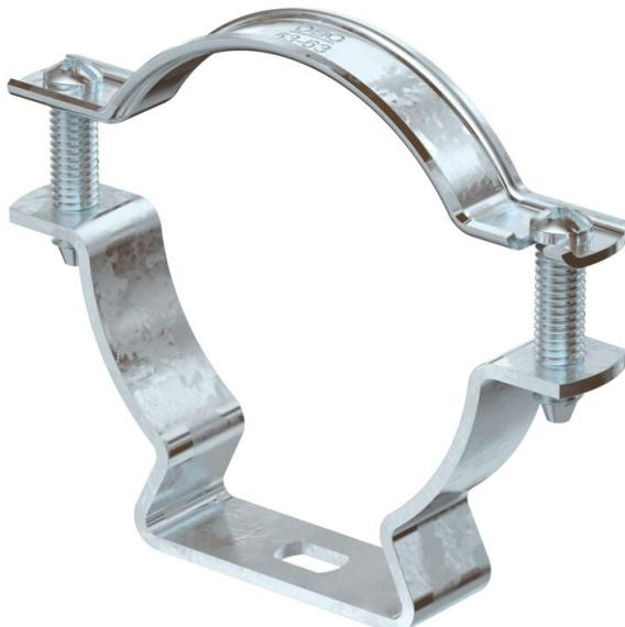
Collier d'écartement pour le montage de tubes et câbles au mur, au plafond et au sol. Avec partie supérieure autobloquante. Fixation par trou oblong. Homologation pour la sécurité de fonctionnement selon la norme DIN 4102 partie 12, classes de sécurité de fonctionnement E30 à E90.
