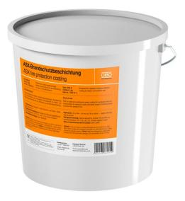
Enduit mixte, endothermique et résistant aux intempéries, pour l'intérieur et l'extérieur. Enduit de protection universel pour les câbles et les structures et supports de câbles. Application directe en tant qu'enduit, remuer si utilisé comme peinture. Quantité suffisante pour une surface de 4 m².
