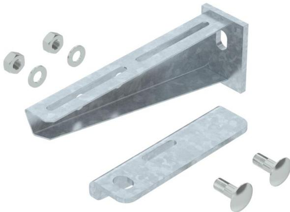
Console pour montage sur pendards ou mural et le type de pose avec chemins de câbles au-dessus de plafonds coupe-feu, et pour ces types de pose au moyen d'échelles à câbles et de chemins de câbles pour le maintien en fonction selon DIN 4102 partie 12. Les consoles sont livrées prémontées.
