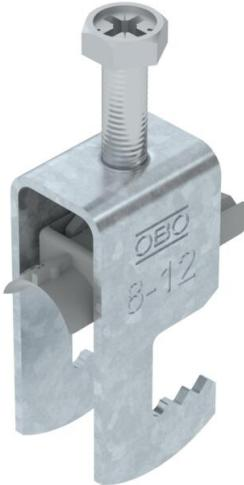
Bride de fixation avec pied F, plaque de pression en matière plastique en polypropylène. Pour montage vertical et horizontal d'1 câble individuel sur des fers plats. Avec vis à 1 filet sur plaque de pression, tête de vis hexagonale universelle SW10, avec fente et empreinte cruciforme. Convient au montage en intérieur et en extérieur. L'utilisation d'une contre-plaque est recommandée.
