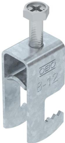
Bride de fixation avec pied F, plaque de pression en métal avec bords arrondis pour la protection des câbles. Pour montage vertical et horizontal d'un câble individuel sur des fers plats. Avec vis à 1 filet sur plaque de pression, tête de vis hexagonale universelle SW10, avec fente et empreinte cruciforme. Convient au montage en intérieur et en extérieur. L'utilisation d'une contre-plaque est recommandée.
