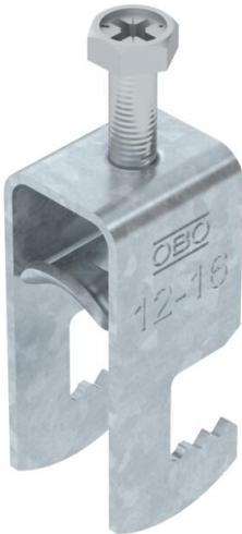
Bride de fixation avec pied F, plaque de pression en métal avec bords arrondis pour la protection des câbles. Pour montage vertical et horizontal d'1 câble individuel sur des fers plats. Avec vis à 1 filet sur plaque de pression, tête de vis hexagonale universelle SW10, avec fente et empreinte cruciforme. Convient au montage en intérieur et en extérieur. L'utilisation d'une contre-plaque est recommandée.
