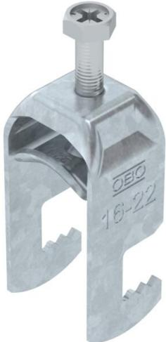
Bride de fixation avec pied F, plaque de pression en métal avec bords arrondis pour la protection des câbles. Pour montage vertical et horizontal d'1 câble individuel sur des fers plats. Avec vis à 1 filet sur plaque de pression, tête de vis hexagonale universelle SW10, avec fente et empreinte cruciforme. Convient au montage en intérieur et en extérieur. L'utilisation d'une contre-plaque est recommandée.
